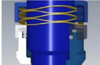
ポンプなどのメカニカルシールの使用例です。圧縮コイルスプリングが使用されることが多いですが、ウェーブスプリングを使用することにより全長を短くすることができます。
